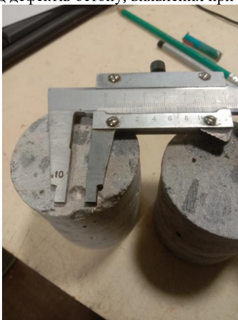
Рис.2 Вигляд дефектів бетону, виявлених при візуальному огляді
