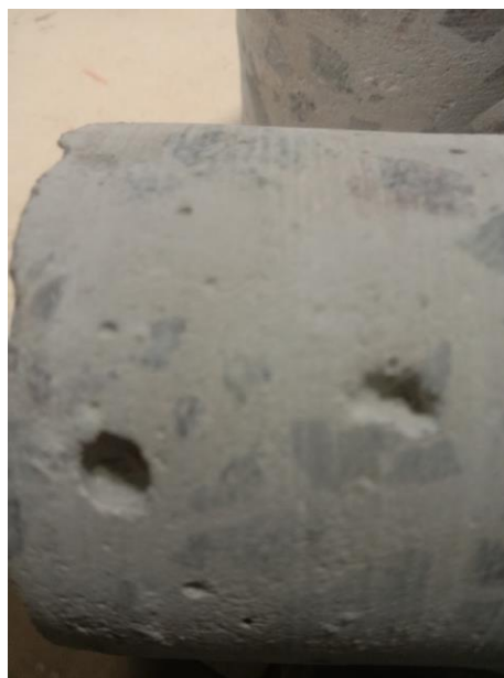
Рис.2 Вигляд дефектів бетону, виявлених при візуальному огляді
