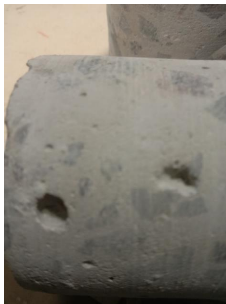
Рис.2 Вигляд дефектів бетону, виявлених при візуальному огляді
