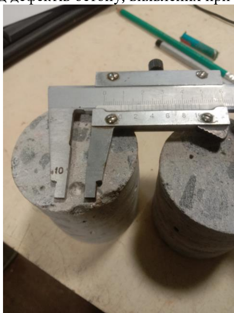
Рис.2 Вигляд дефектів бетону, виявлених при візуальному огляді
